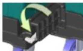
La commande est déconnectée du chariot à timon
